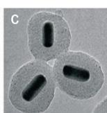
Nanopartikel unter der Lupe: Die Bilder des Transmissionselektronenmikroskops zeigen sphärische Nanopartikel (A), Gold-Nanopartikel (B) und stabförmige Nanopartikel mit Silikaschale (C); Maßstabsskala: 50 nm.
