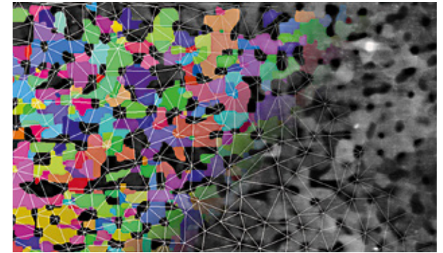
Elektronenmikroskopische Aufnahme einer Silizium-Probe mit Nanokristalliten unterschiedlicher Orientierung (farbig), Poren (schwarz) und dem von der Bildbearbeitungssoftware erkannten Porennetzwerk (weiße Gitterlinien). ©: D. Kojda/HZB
