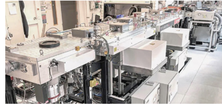
Die am HZB betriebene Clusteranlage ermöglicht es, großflächige Perowskit/Silizium-Tandemsolarzellen herzustellen. Die Anlage ist weltweit einzigartig und trägt dazu bei, neue industriennahe Prozesse, Materialien und Solarzellen zu entwickeln. © B. Stannowski/HZB
