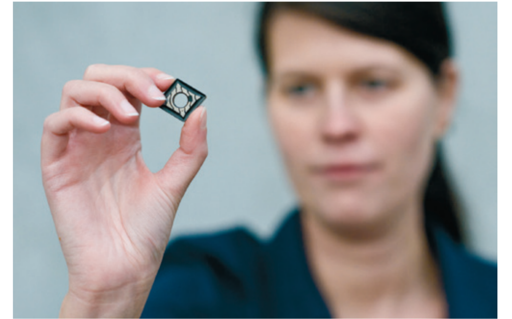
Klein, aber stark wie ein Tiger: Die Wendeschneidplatte ist durch Eigenspannungsanalysen an BESSY II so optimiert worden, dass sie weniger verschleißanfällig ist.
